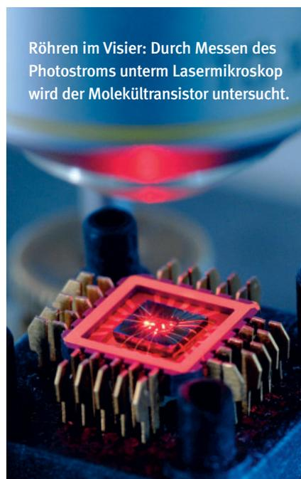
Röhrchen im Visier: Durch Messen des Photostroms unterm Lasermikroskop wird der Molekültransistor untersucht.
