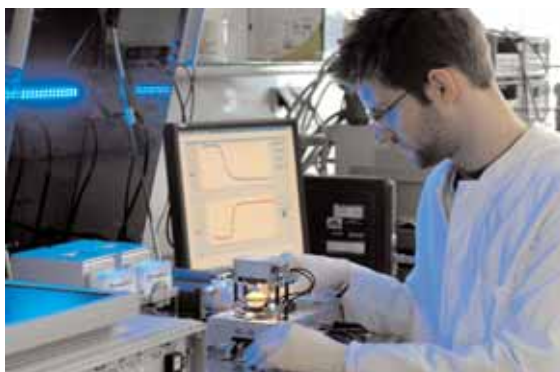
Bilder rechts: Vorrichtung zur Messung der an der Sensoroberfläche (Schwingquarz) angelagerten Erythrozyten
